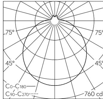
LED 3000 K 31 W 2373 lm-h / CIE Flux 42 71 89 87 100 / B31 nach DIN 5040
