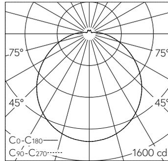
LED 2700 K 47.4 W 4691 lm-h / CIE Flux 43 72 90 92 100 / A31 nach DIN 5040
