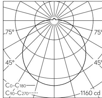
LED 2700 K 32 W 4073 lm-h / CIE Flux 43 72 90 92 100 / A31 nach DIN 5040
