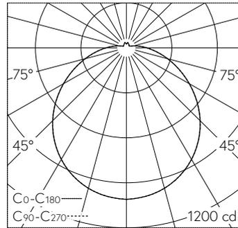
LED 3000 K 32 W 4073 lm-h / CIE Flux 43 72 90 92 100 / A31 nach DIN 5040
