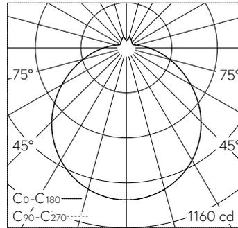
LED 2700 K 48.8 W 3581 lm-h / CIE Flux 42 71 89 88 100 / B31 nach DIN 5040
