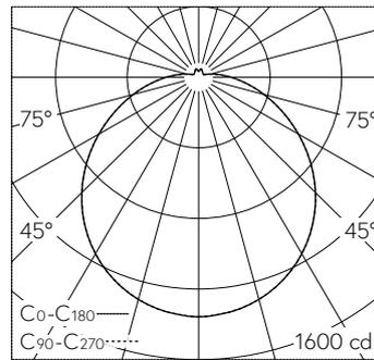
LED 2700 K 49 W 5801 lm-h / CIE Flux 43 72 90 92 100 / A31 nach DIN 5040
