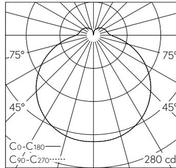
LED 2700 K 10.5 W 951 lm-h / CIE Flux 40 70 89 84 100 / B31 nach DIN 5040
