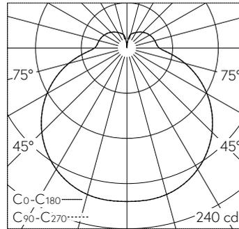
LED 2700 K 15.5 W 970 lm-h / CIE Flux 38 68 88 79 100 / B31 nach DIN 5040
