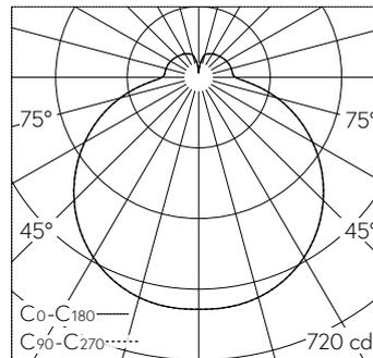
LED 3000 K 31.1 W 2592 lm-h / CIE Flux 40 70 89 81 100 / B32 nach DIN 5040
