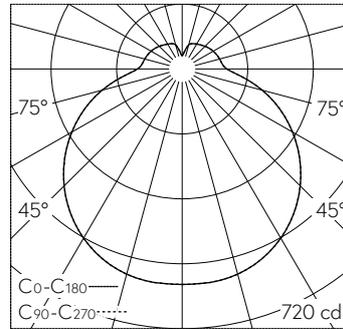
LED 3000 K 31 W 2822 lm-h / CIE Flux 39 68 88 79 100 / B32 nach DIN 5040
