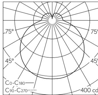
LED 3000 K 19.6 W 1473 lm-h / CIE Flux 39 68 88 78 100 / B32 nach DIN 5040
