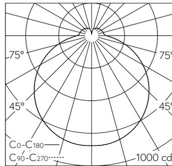
LED 3000 K 29.4 W 3384 lm-h / CIE Flux 41 71 90 85 100 / B32 nach DIN 5040
