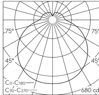
LED 2700 K 31 W 2730 lm-h / CIE Flux 39 68 88 79 100 / B32 nach DIN 5040
