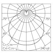
LED 2700 K 16.8 W 970 lm-h / CIE Flux 38 68 88 79 100 / B31 nach DIN 5040
