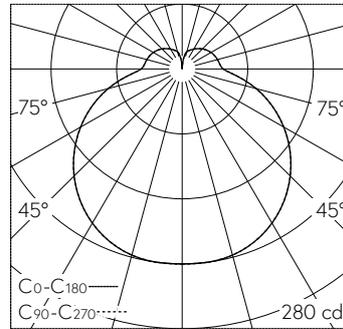
LED 3000 K 16.8 W 1001 lm-h / CIE Flux 38 68 88 79 100 / B31 nach DIN 5040
