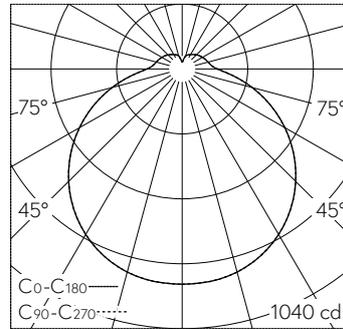
LED 3000 K 32 W 4846 lm-h / CIE Flux 40 70 89 84 100 / B31 nach DIN 5040
