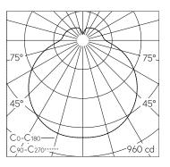
LED 3000 K 49 W 5385 lm-h / CIE Flux 38 67 87 77 100 / B32 nach DIN 5040
