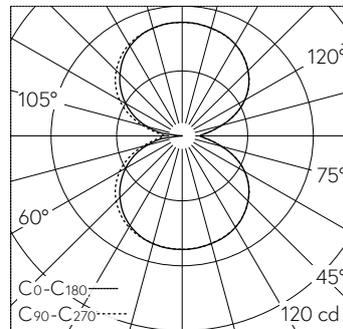
LED 3000 K 9 W 541 lm-h / CIE Flux 38 68 88 50 100 / C33 nach DIN 5040
