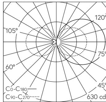
LED 3000 K 27 W 2840 lm-h / CIE Flux 13 37 66 50 100 / C11 nach DIN 5040
