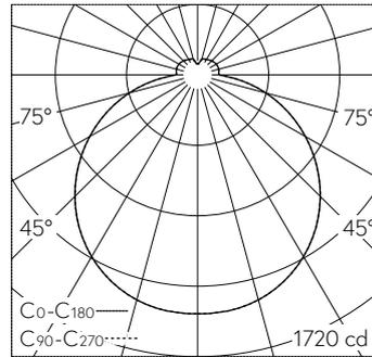
LED 3000 K 63 W 5592 lm-h / CIE Flux 42 72 91 86 100 / B32 nach DIN 5040
