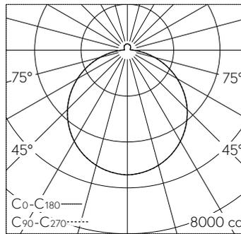
LED 3000 K 134 W 17294 lm-h / CIE Flux 45 76 93 94 100 / A42 nach DIN 5040
