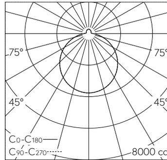
LED 4000 K 100 W 13324 lm-h / CIE Flux 44 75 92 90 100 / A42 nach DIN 5040
