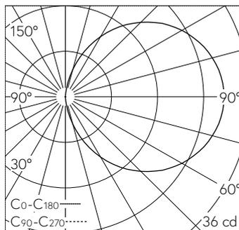
LED 3000 K 3 W 87 lm-h / CIE Flux 13 37 66 50 100 / C11 nach DIN 5040
