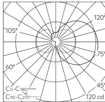
LED 3000 K 7.4 W 437 lm-h / CIE Flux 16 41 69 48 100 / C12 nach DIN 5040
