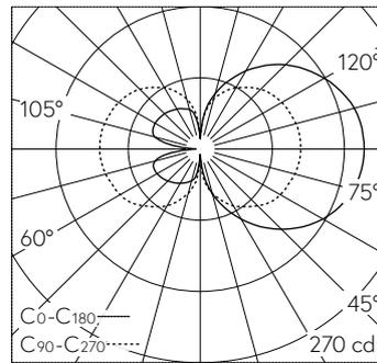
LED 3000 K 18.8 W 1590 lm-h / CIE Flux 17 42 69 49 100 / C12 nach DIN 5040
