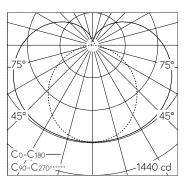
LED 3000 K 62 W 6511 lm-h / CIE Flux 33 60 82 73 100 / B21 nach DIN 5040
