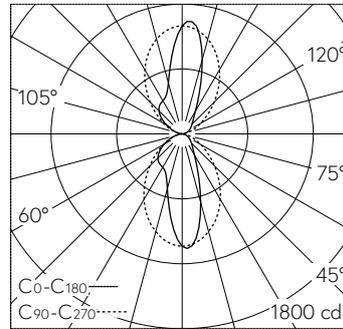
LED 3000 K 28.4 W 2571 lm-h / CIE Flux 61 87 98 50 100 / C54 nach DIN 5040
