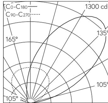
LED 3000 K 19.1 W 2063 lm-h / CIE Flux 0 0 0 100 / E83 nach DIN 5040
