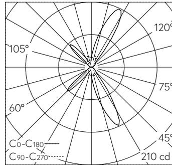
LED 3000 K 10 W 168 lm-h / CIE Flux 67 93 99 49 100 / C64 nach DIN 5040
