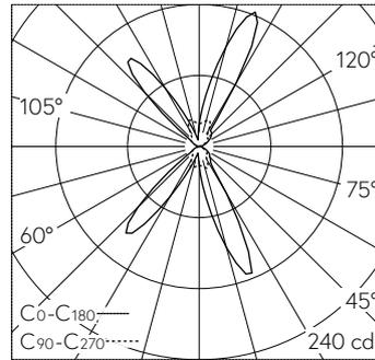
LED 3000 K 14 W 214 lm-h / CIE Flux 67 93 99 48 100 / C64 nach DIN 5040
