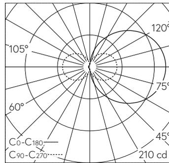
LED 3000 K 7.8 W 698 lm-h / CIE Flux 14 39 67 50 100 / C11 nach DIN 5040
