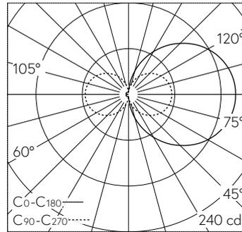
LED 2700 K 10 W 829 lm-h / CIE Flux 14 39 67 50 100 / C11 nach DIN 5040
