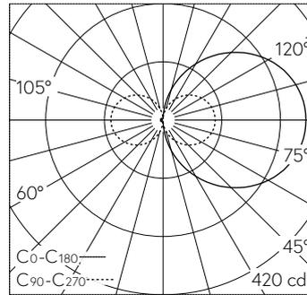
LED 2700 K 16.1 W 1444 lm-h / CIE Flux 14 38 67 50 100 / C11 nach DIN 5040
