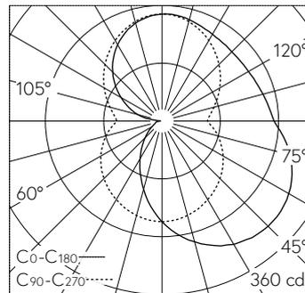
LED 3000 K 30 W 1912 lm-h / CIE Flux 31 58 80 51 100 / C22 nach DIN 5040
