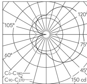
LED 3000 K 10 W 750 lm-h / CIE Flux 28 55 79 50 100 / C22 nach DIN 5040
