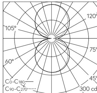
LED 3000 K 20 W 1189 lm-h / CIE Flux 43 72 91 50 100 / C33 nach DIN 5040
