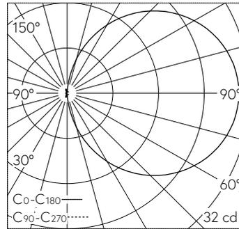
LED 2700 K 3 W 91 lm-h / CIE Flux 14 38 67 50 100 / C11 nach DIN 5040
