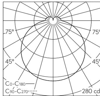
LED 3000 K 9.5 W 957 lm-h / CIE Flux 40 69 89 83 100 / B31 nach DIN 5040
