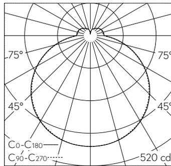
LED 2700 K 17,6 W 1839 lm-h / CIE Flux 41 70 90 84 100 / B31 nach DIN 5040
