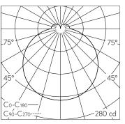
LED 2700 K 10.5 W 942 lm-h / CIE Flux 40 69 89 83 100 / B31 nach DIN 5040
