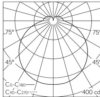
LED 3000 K 15.7 W 1513 lm-h / CIE Flux 39 68 88 82 100 / B31 nach DIN 5040
