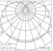
LED 3000 K 73 W 8108 lm-h / CIE Flux 34 61 82 69 100 / B21 nach DIN 5040
