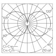
LED 4000 K 18 W 1699 lm-h / CIE Flux 17 41 69 51 100 / C11 nach DIN 5040
