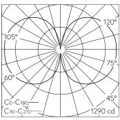
LED 4000 K 104.8 W 11566 lm-h / CIE Flux 18 44 71 51 100 / C11 nach DIN 5040
