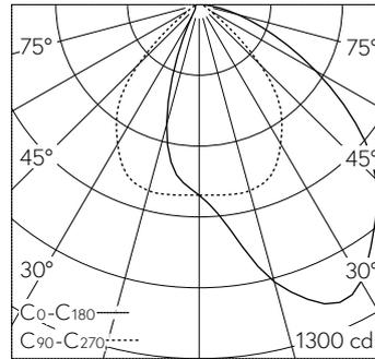
LED 3000 K 13.5 W 1526 lm-h / CIE Flux 60 89 98 100 100 / A50 nach DIN 5040
