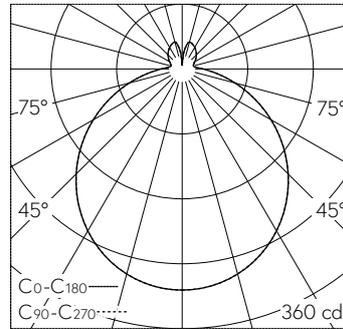
LED 3000 K 15.5 W 1087 lm-h / CIE Flux 44 74 91 86 100 / B42 nach DIN 5040
