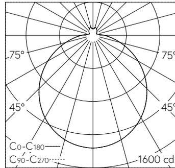
LED 2700 K 48 W 4595 lm-h / CIE Flux 44 74 91 90 100 / A42 nach DIN 5040
