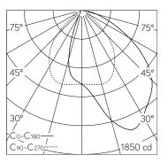
LED 3000 K 19.5 W 2129 lm-h / CIE Flux 60 89 98 100 100 / A50 nach DIN 5040
