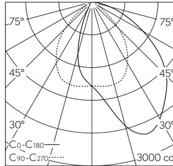
LED 3000 K 27.6 W 3339 lm-h / CIE Flux 60 88 98 100 100 / A50 nach DIN 5040
