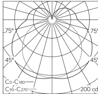
LED 2700 K 9.3 W 904 lm-h / CIE Flux 35 64 85 74 100 / B31 nach DIN 5040
